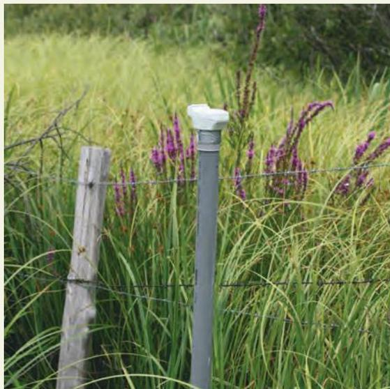
**Piézomètre équipé d'une sonde de mesure automatique**
